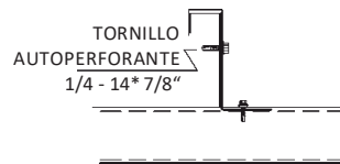
FIJACION TRASLAPO PANELAS-2 FIJACION GANCHO FIJO
